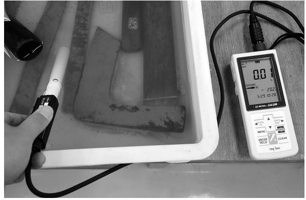
⑥電気伝導率計を用いた脱塩効果の測定
