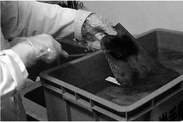
③次亜塩素酸ナトリウム水溶液を用いた洗浄
