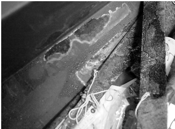
写真3 乾燥後吸湿し再度錆が進行した大工道具
